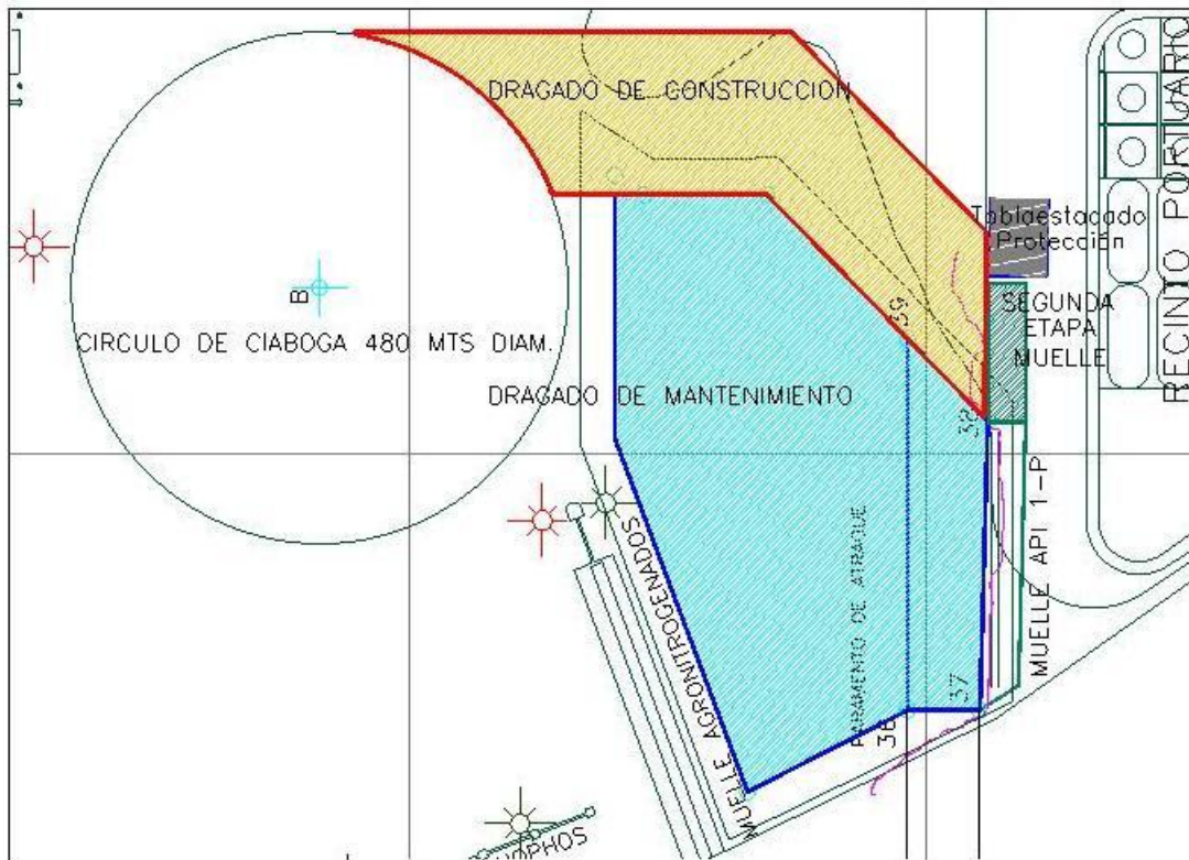
Figura IV.1.5. Disposición en plata del dragado de construcción y de mantenimiento en el Recinto Portuario de Pajaritos, Etapa 2.
