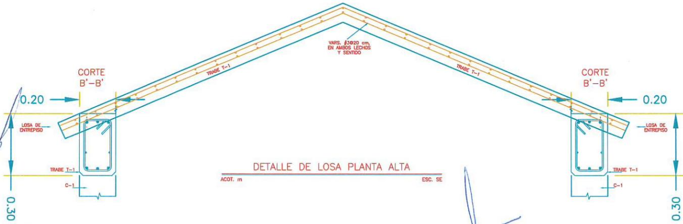
DETALLE DE LOSA PLANTA ALTA
